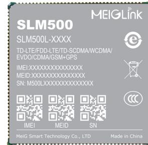
SLM500L 系列核心板，采用高通骁龙 400 系列的 SDM450，该 CPU 采用 14nm FinFET 制程，内置 64bit ARM、8 核 A53 (4\*1.8GHz)，支持 Decode/encode 最高 4K@30fps、H.265，支持 FHD 屏幕分辨率，支持两路 ISP 摄像头，搭载 Android 10 操作系统，支持板卡内存为 2GB+16GB (3GB+32GB)，支持 LTE Cat4，最大下行速率可达 150Mbps，最大上行速率可达 50Mbps。支持 TD-LTE/FDD-LTE/WCDMA/EVDO/TD-SCDMA/CDMA/GSM 多种网络制式，集成了 GNSS 和 2.4&5G WIFI 的宽带智能无线通信模块。
